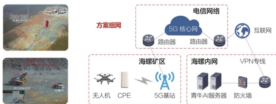
图 99 无人机爆破巡检和地貌更新分析应用
