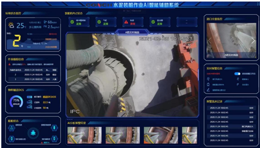
图 101 水泥装船作业 AI 智能辅助系统
