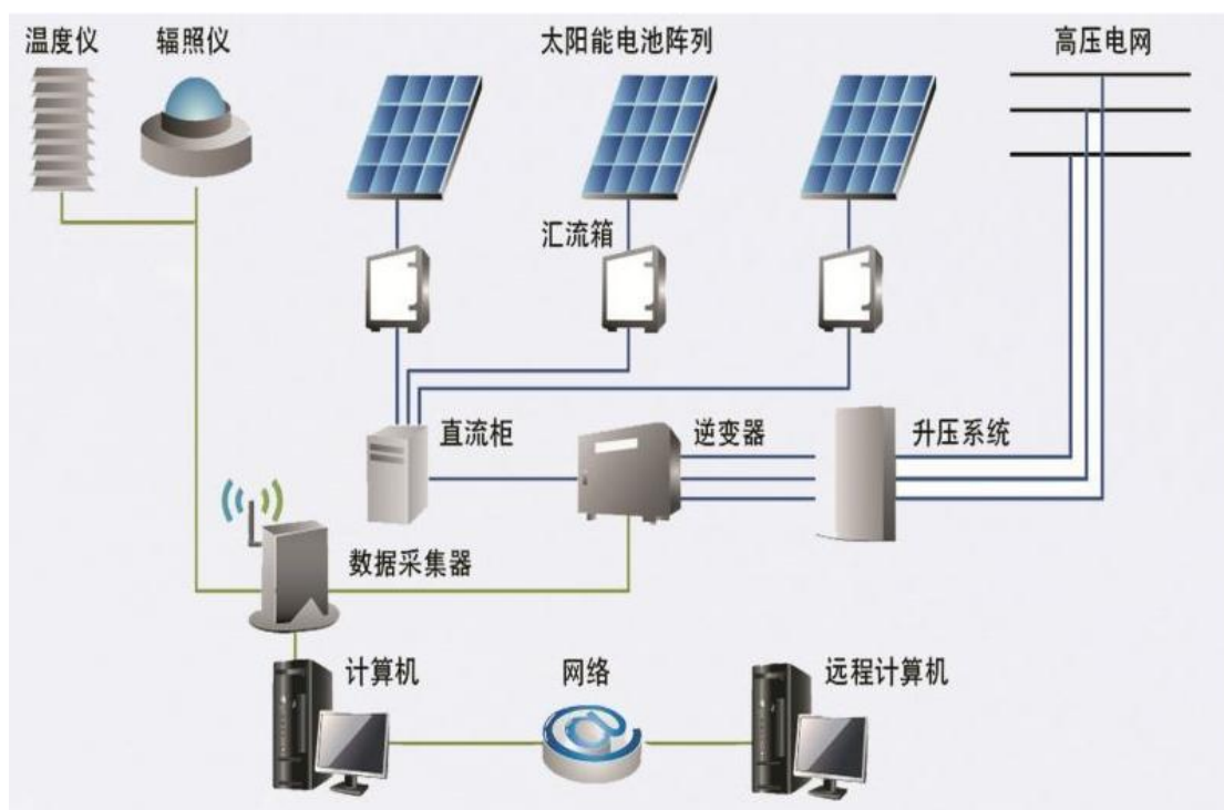
图 7-4 新能源光伏发电工艺流程
