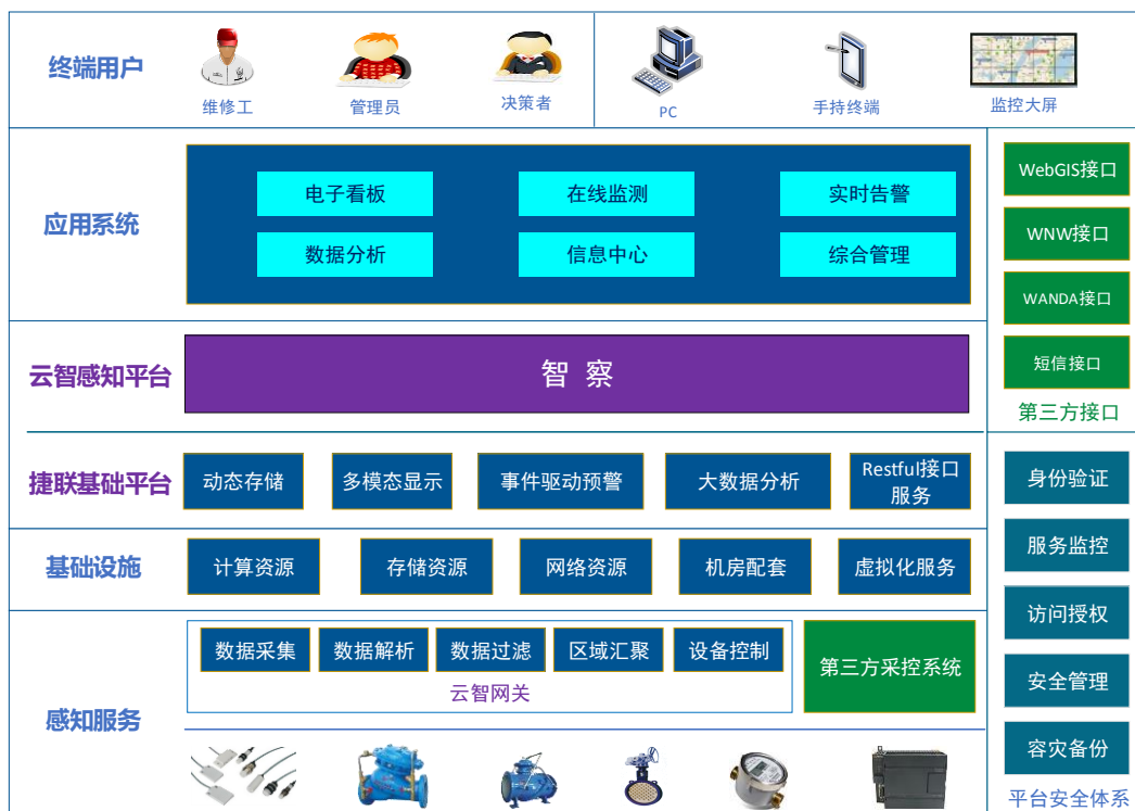
图 3 基于物联感控技术的通用物联网解决方案功能架构
