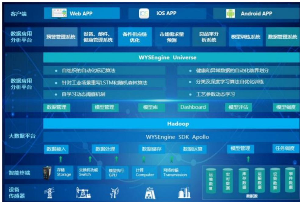
图 26 工业设备故障预测分析系统 APP 架构图
